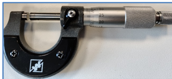
Palmer dont on lit l'épaisseur : 2,00 \pm 0,26 \text{ mm}
