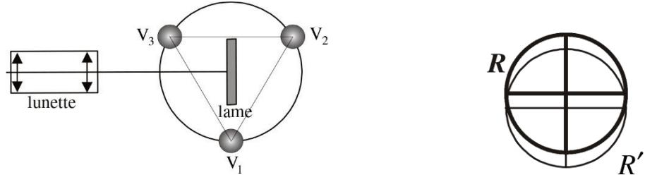
3°) En agissant sur la vis V' de réglage de l'horizontalité de l'axe de la lunette, faire coïncider les fils horizontaux de R et de R'. L'axe de la lunette est alors perpendiculaire aux faces de la lame, mais celle-ci peut être inclinée d'un angle  $\varepsilon$  avec l'axe du plateau.
