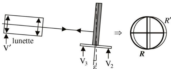
4°) Tourner le plateau de  $180^\circ$ , en général, l'image du fil horizontal R' ne coïncide plus avec celui de R. En effet, les rayons incidents provenant de la lunette arrivent sur la lame avec un angle d'incidence égal à  $2\varepsilon$  et la distance entre les traits horizontaux de R et R' vaut  $4\varepsilon f'$  dans le plan focal de l'objectif de la lunette de distance focale image  $f'$ .
