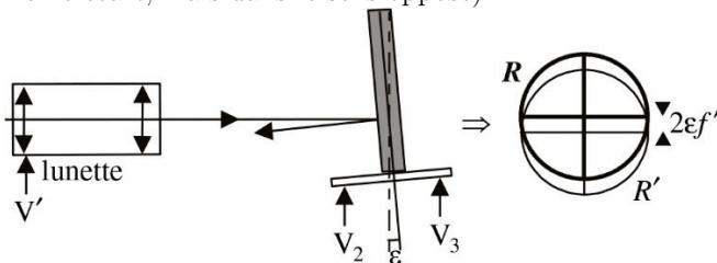
6°) Agir sur les vis V2 et V3 (sensiblement de la même quantité) de réglage de l'inclinaison du plateau de façon à faire coïncider les traits horizontaux de R et R'. Cette opération doit rendre les faces de la lame parallèles à l'axe du plateau. Le réglage de V', V2 et V3 serait terminé si la division par 2 du  $5^\circ$  était exacte.
