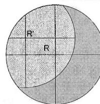
Réticule et image de retour sont bien dans le même plan lorsque en donnant à l'œil de petits déplacements latéraux derrière l'oculaire, on ne constate aucun déplacement relatif de R et R'.
