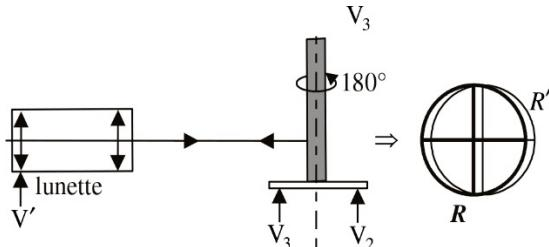
Le réglage précédent étant effectué, ne plus toucher par la suite à la vis de réglage  $V'$  de l'horizontalité de l'axe de la lunette. On pourra toutefois modifier le réglage de l'horizontalité du plateau en jouant sur  $V_1$ ,  $V_2$ ,  $V_3$  pour que le plan du réseau soient bien parallèles à l'axe du plateau.
