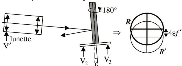
5°) Agir sur la vis V' de la lunette de façon à diviser à vue l'écart entre les fils horizontaux par 2. Si cette distance est bien évaluée, cela revient à rendre l'axe de la lunette orthogonal à celui du plateau (si l'on faisait tourner de nouveau le plateau de  $180^\circ$ , on devrait retrouver le même écart, mais dans le sens opposé).
