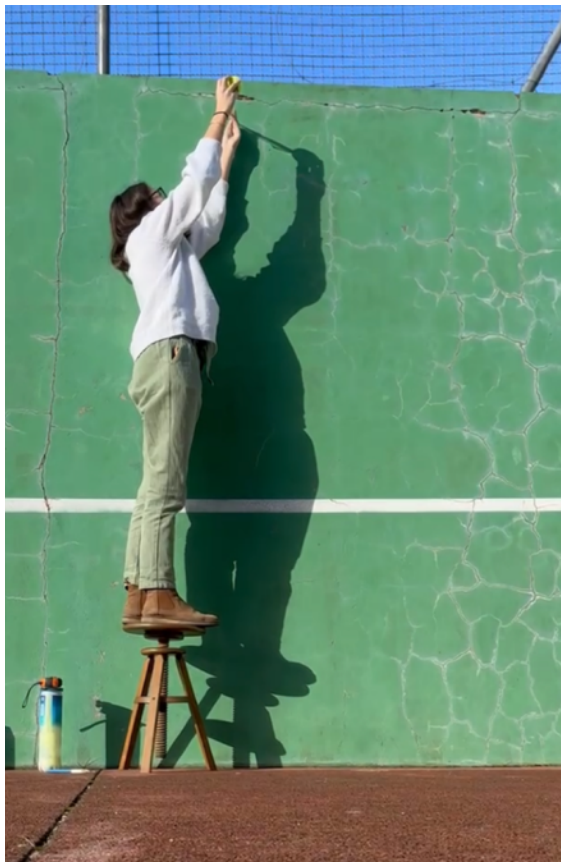
Figure 1 Balle lâchée sur du béton, H = 2,54\text{m}
