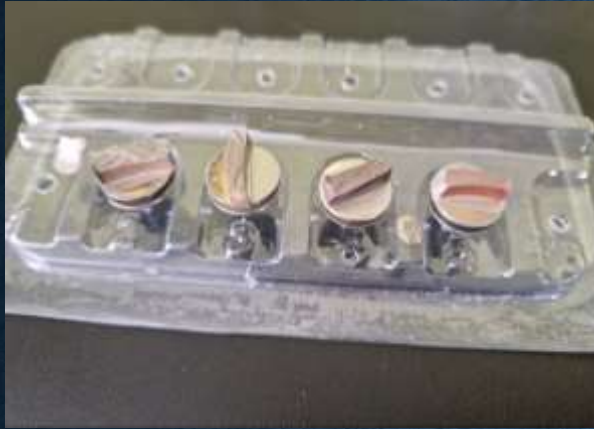
Échantillons des 4 balles avec dépôts de carbone
