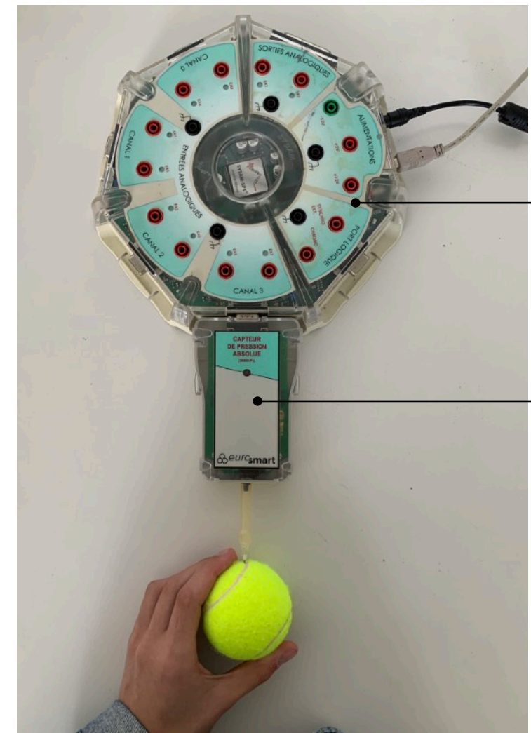
Figure 6 Dispositif de mesure de la pression interne des balles de tennis
