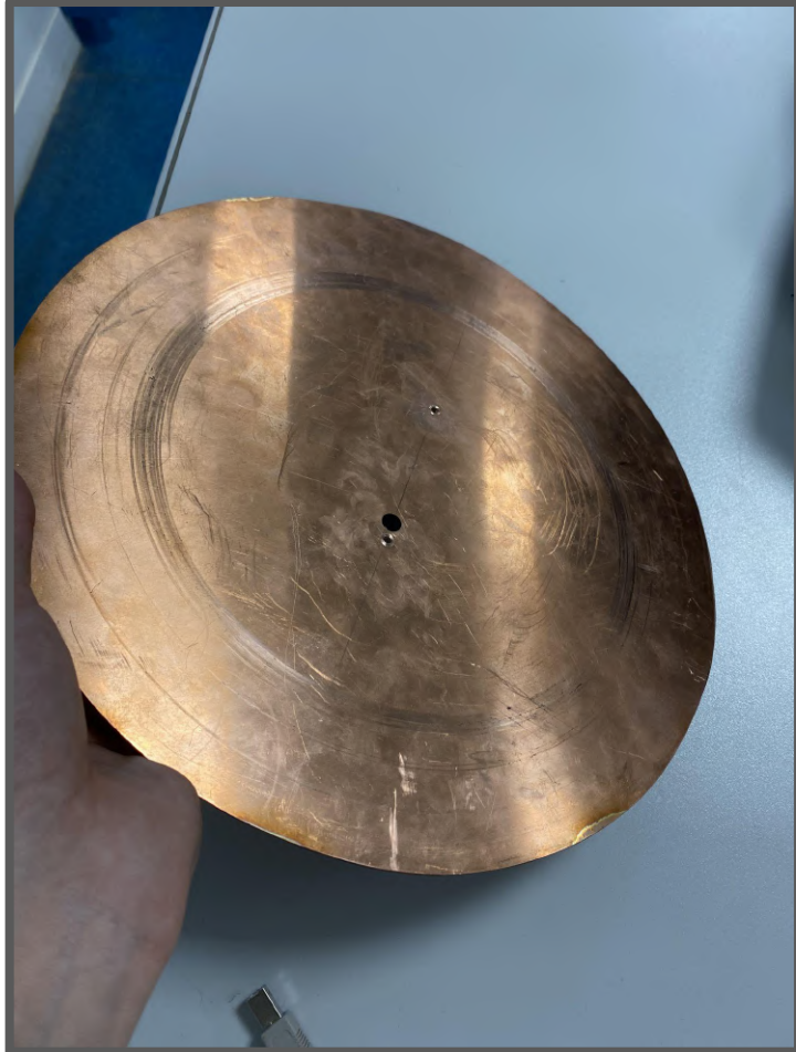
Traces d'usures dues au freinage à patins
