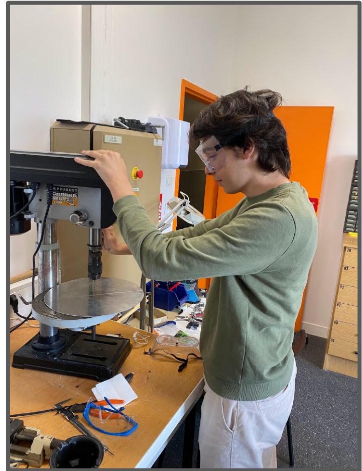
Perçage des trous pour lier les disques au moteur
