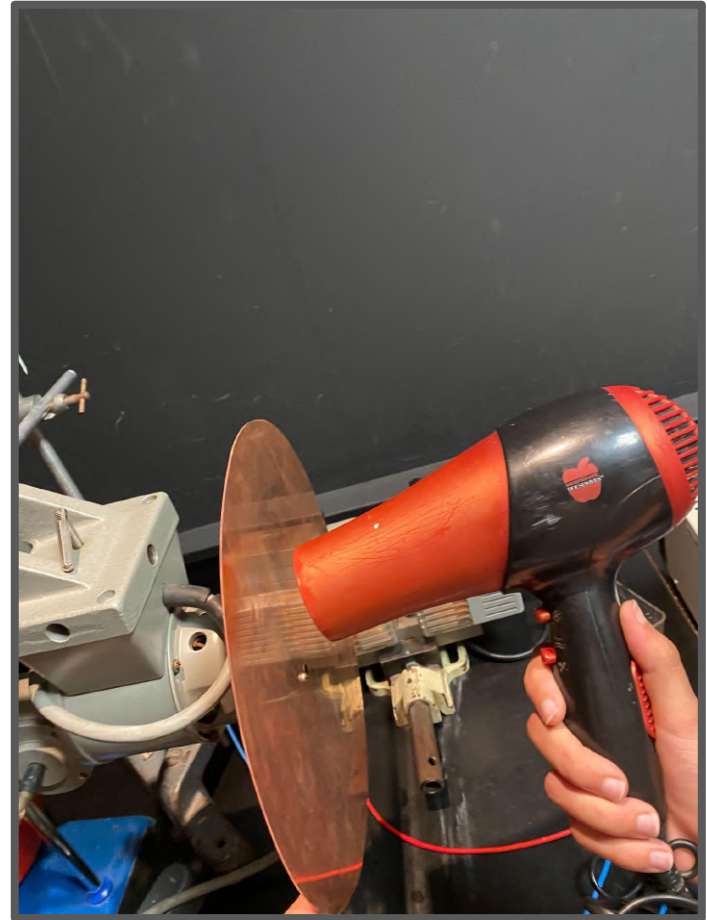
Chauffe du disque à l'aide d'un sèche-cheveux
