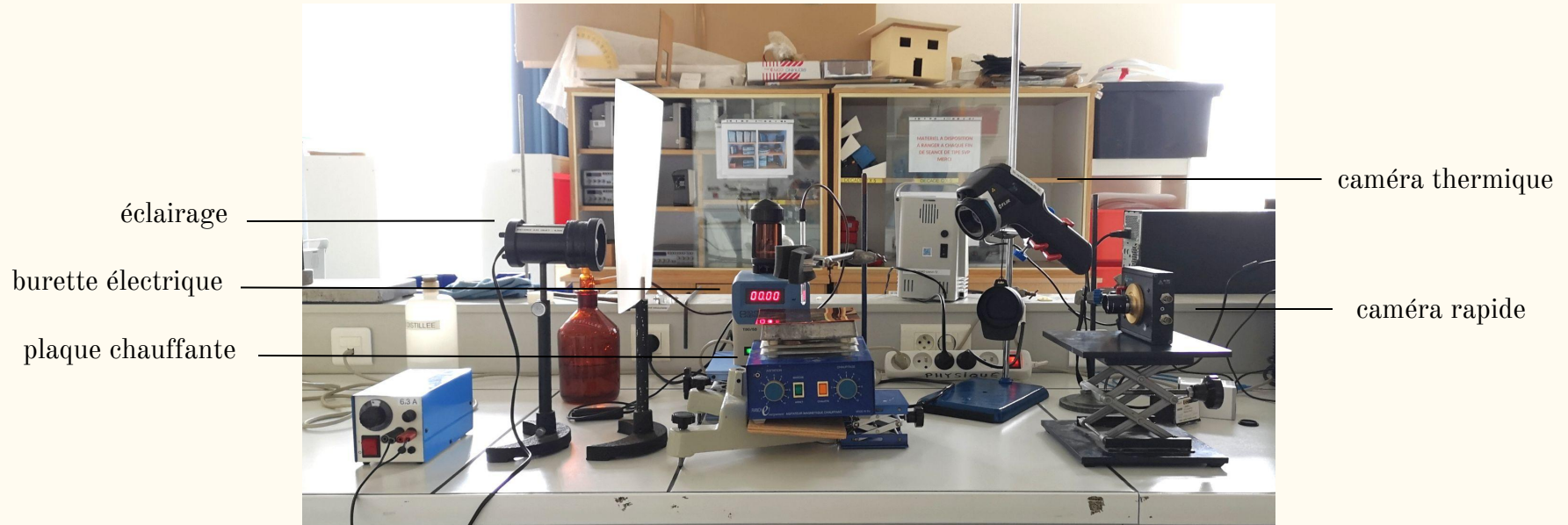
Montage pour la mesure du temps de vie d'une goutte
