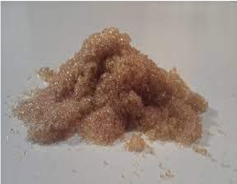
Figure 5 : Image et photo de résines échangeuses d'ions
