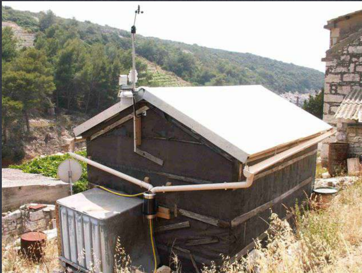
Le toit et les sondes de condensation sur l'île de Biševo, Croatie
