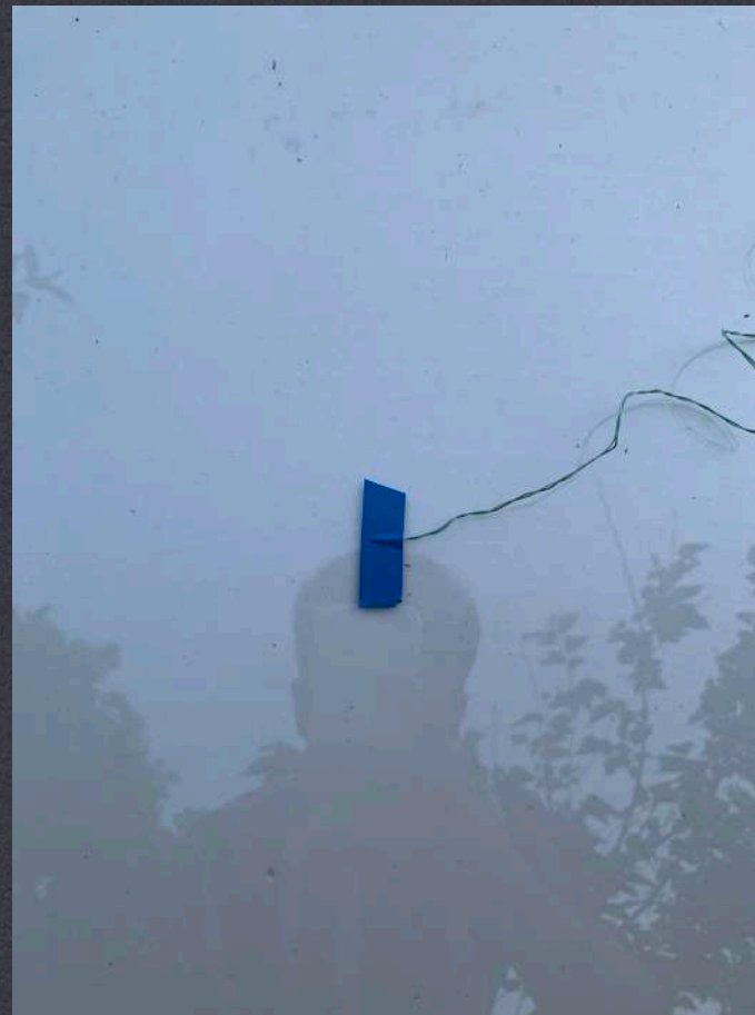
Installation du thermocouple sur la plaque de PMMA
