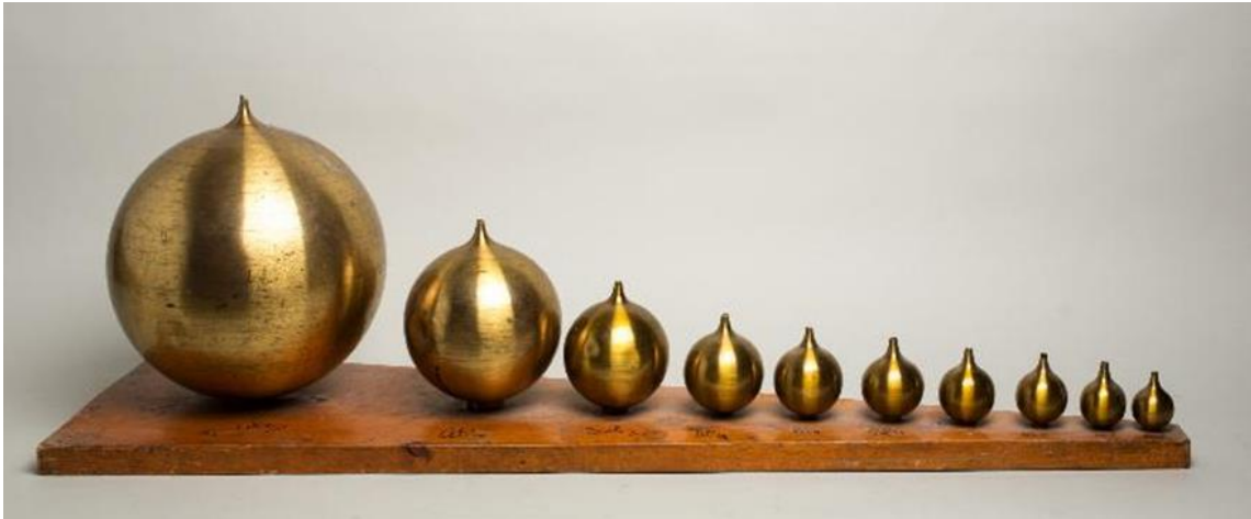
Résonateurs en laiton de différentes tailles imaginés par Helmholtz pour ses premiers travaux
