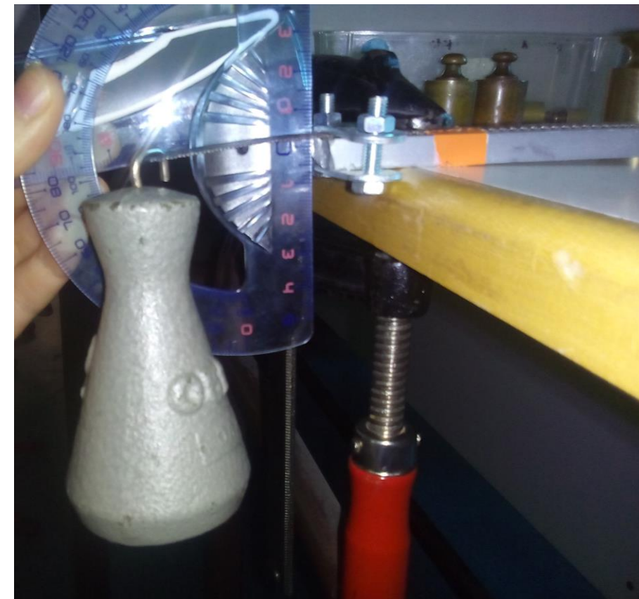
Mesure de l'angle de torsion de la lame
