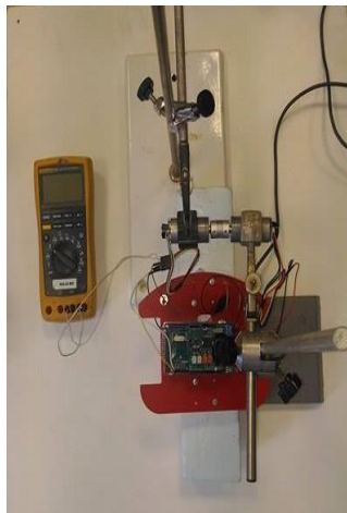
Essai à vide en génératrice
