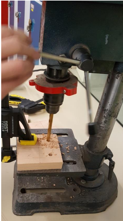
Pré-perçage des trous accueillant les tourillons
