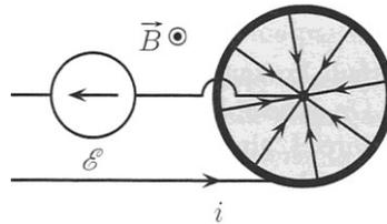
Schéma simplifié d'un moteur rotatif à entrefer plan. La roue peut pivoter autour de son axe. Seuls quelques rayons (ici, huit rayons disposés à  $45^\circ$ ) de la roue sont conducteurs électriques.
