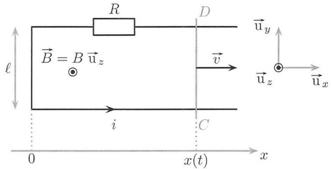
*Rails de Laplace. Le dispositif baigne dans un champ magnétique uniforme créé par un aimant en fer à cheval. La barre [CD], seule partie mobile, est mise en mouvement à la vitesse  $\vec{v}$  par un opérateur. Un ampèremètre, non représenté sur le schéma, mesure l'intensité  $i$  du courant induit. L'orientation de l'intensité est arbitraire.*
