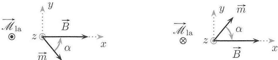
Effet mécanique du couple  $\vec{M}_{la} = \vec{\Gamma} = \vec{m} \wedge \vec{B}$  sur un moment magnétique  $\vec{m}$ .
