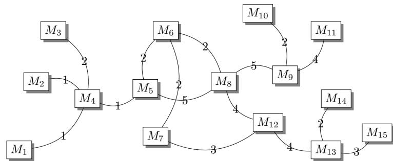
Le schéma ci-dessus représente un réseau d'appareils connectés qui peuvent être des ordinateurs, des smartphones, des boîtiers internet, des routeurs. Les arêtes représentent les connexions filaires ou sans fil. Les nombres sont les temps de transmission en unité de temps.
