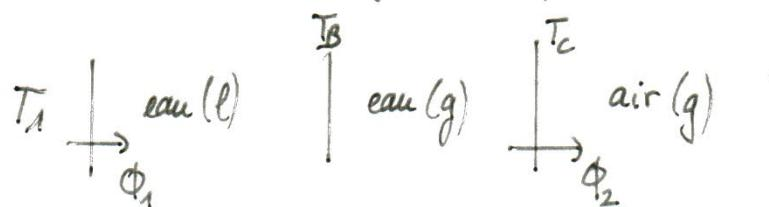
La partie représentée par le flux  $\phi$  est due au changement d'état de l'eau liquide en vapeur. Le reste correspond à l'association des résistances thermiques.
