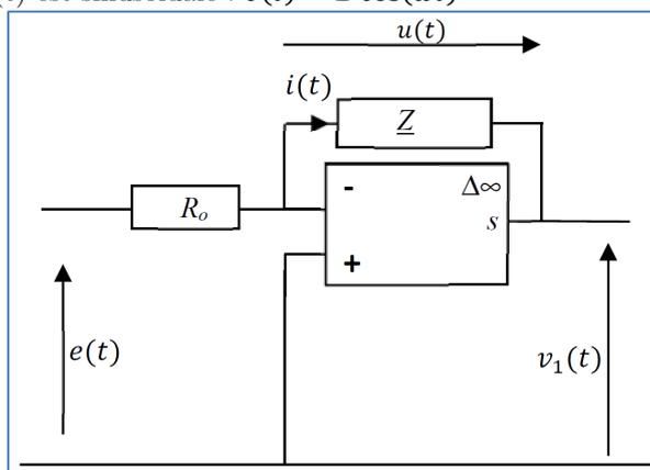
Fig 1. Convertisseur tension/courant
