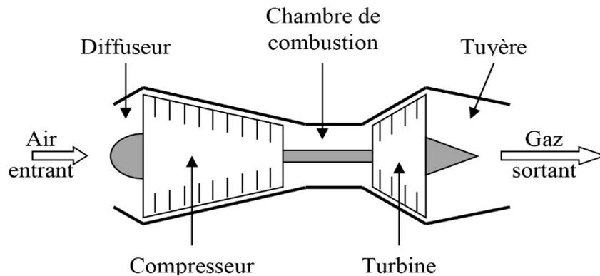
**Figure 12** - Schéma de principe d'un turboréacteur simple flux
