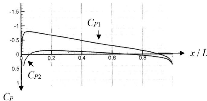
**Figure 3** - Coefficient de pression sur l'intrados et l'extrados
