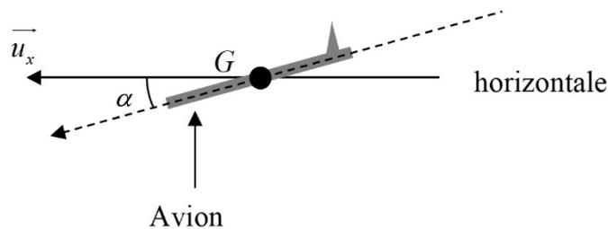
**Figure 6** - Avion en mouvement rectiligne uniforme sans propulsion
