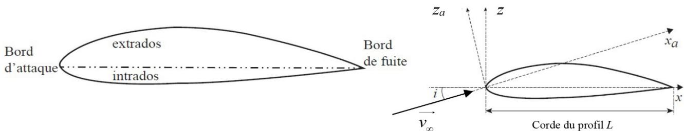
**Figure 1** - Caractéristiques géométriques du profil d'une aile d'avion
