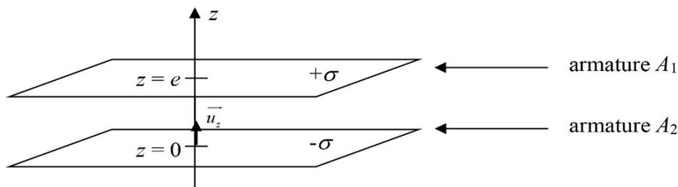
**Figure 10** - Condensateur plan
