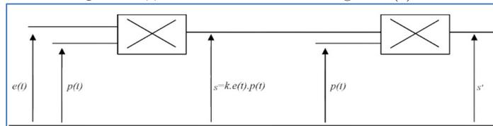
a) Quelle est la condition de Barkhausen des oscillations pour le montage « bloc » suivant :
