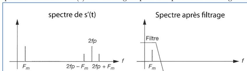
Un filtre passe-bande centré sur  $f_m$  ou un filtre passe-bas de fréquence de coupure tel que  $f_c \in [10f_m ; \frac{2f_p - f_m}{10}]$  peut réaliser cette opération par exemple.
