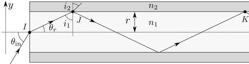
FIGURE 3 – Schéma d'une fibre à saut d'indice
