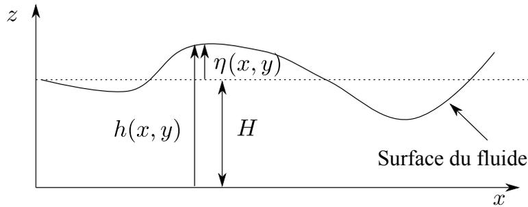
FIGURE 6 – La hauteur locale de la surface du fluide est notée  $h(x, y)$ . Les quantités  $H$  et  $\eta$  sont introduites dans la partie 5.2.
