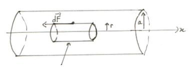
Ne cytinche de volume d'é subst une force de cisaillement du type :  $d\vec{F} = -m_e dS \frac{\partial V}{\partial r} \vec{u}_{\chi}$
