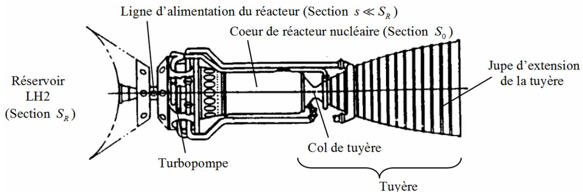
**Figure 2** Plan du moteur NERVA
