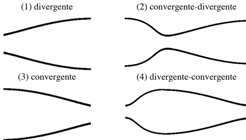
**Figure 4** Les quatre géométries différentes des tuyères
