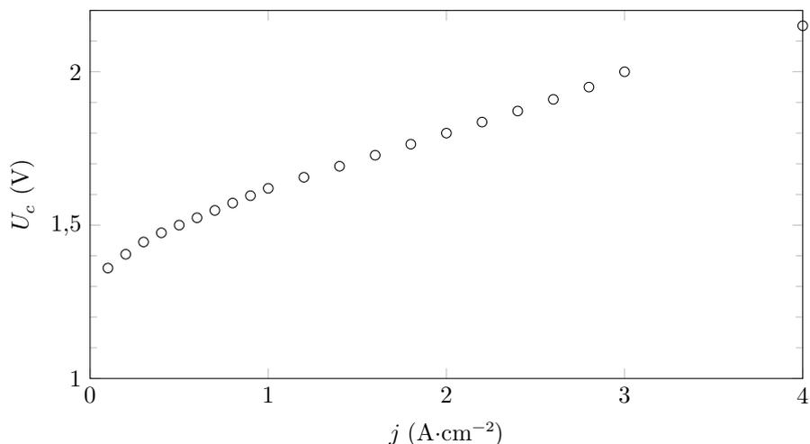
Figure 6 Caractéristique  $U_c = f(j)$  d'un électrolyseur
