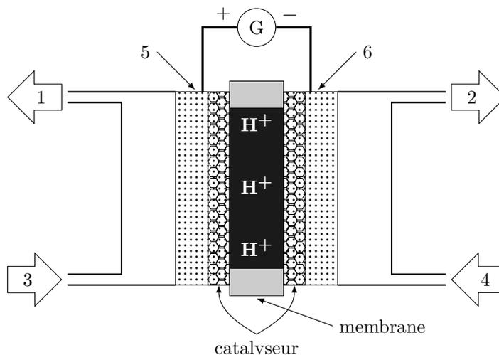
**Figure 5** Schéma d'un électrolyseur à électrolyte polymère solide
