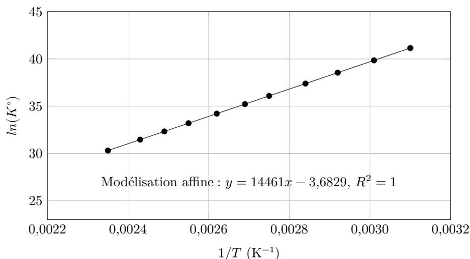
**Figure 8** Tracé de  $\ln(K^\circ) = f(1/T)$  pour l'équation (II.1)
