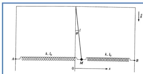
Un pendule simple (point matériel  $M$  de masse  $m$  au bout d'un fil inextensible, de masse négligeable et de longueur  $l$ ) est lié à deux ressorts accrochés en  $A$  et  $B$ . Les deux ressorts sont identiques : longueur à vide  $l_0$  et raideur  $k$ . Quand le pendule est vertical, les deux ressorts sont au repos. Les élongations angulaires du pendule sont faibles de façon à pouvoir considérer en permanence les deux ressorts horizontaux.
