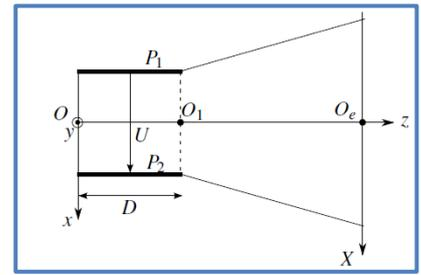
1. Calculer la force subie par les électrons en fonction de  $U, q, d$  et  $\vec{u}_x$ . (Rappel :  $E = \frac{U}{d}$ )
