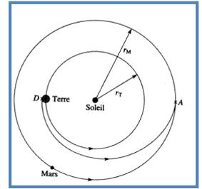
On suppose que le vaisseau n'est soumis qu'à l'attraction gravitationnelle du Soleil (on néglige celle de la Terre), que le rayon de l'orbite de parking est négligeable devant la distance Terre-Soleil et que la vitesse du vaisseau dans le référentiel héliocentrique au départ est la même que celle de la Terre sur son orbite autour du Soleil.
