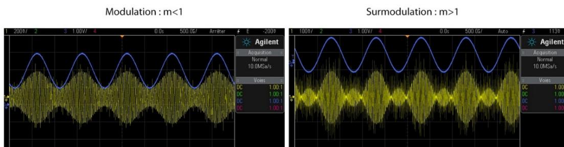
Q4) En observant simultanément le signal de sortie et le signal modulant  $m(t)$ , conclure sur la nécessité d'avoir  $m < 1$  pour récupérer l'information contenue dans  $m(t)$  si on utilise la détection d'enveloppe comme méthode de démodulation.
