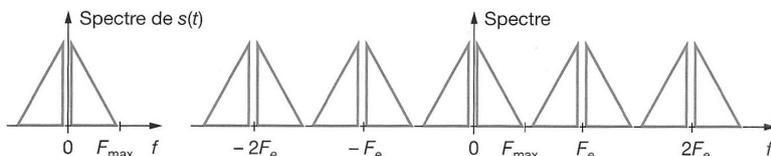
Si l'on appelle  $f_{max}$  la valeur la plus élevée des fréquences présente dans le spectre de  $s(t)$ , on écrit que cette disjonction des intervalles spectraux est obtenue lorsque  $f_{max} < f_e - f_{max}$ , c'est-à-dire:
