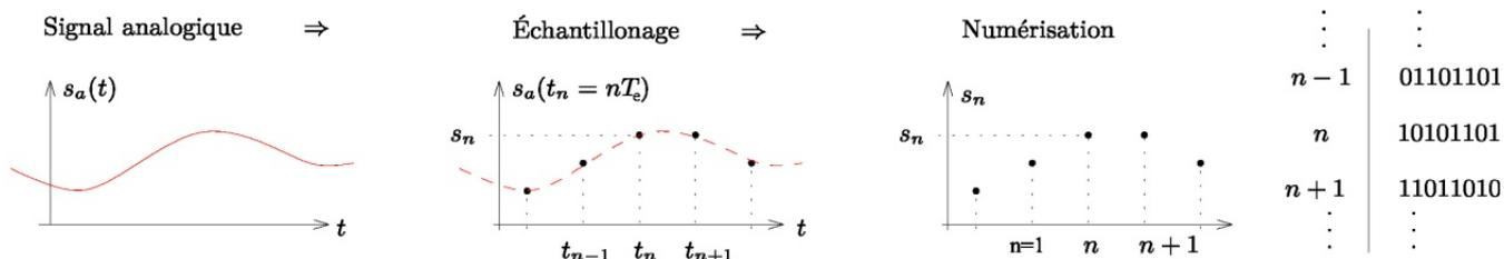
À partir des  $N_e$  échantillons qui représente le signal  $s(t)$  par ces valeurs  $s_n = s(t_n) = s(nT_e)$  du signal  $s(t)$ , un traitement mathématique appelé transformée de Fourier discrète (TFD) fournit le spectre. L'algorithme utilisé pour ce calcul se nomme transformée de Fourier rapide et s'abrège en anglais par les trois lettres FFT. L'algorithme le plus utilisé est celui de Cooley-Tukey ce qui donne le nom abrégé de FFT(CT).
