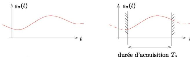
Ainsi, dans un dispositif numérique,  $s(t)$  est mesuré seulement à  $N_e$  instants  $t_n$  équidistants et séparés les uns des autres d'une durée  $T_e$  :  $s_n = s(t_n) = s(nT_e)$ . On dit que le signal est échantillonné et la fréquence  $f_e = \frac{1}{T_e}$  s'appelle fréquence d'échantillonnage. La durée d'observation est donc :  $T_a = N_e T_e$ .
