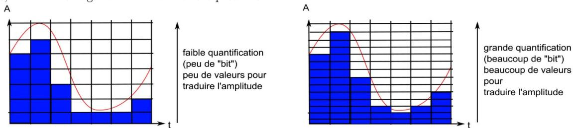
Dans le cas de la carte Sysam on appelle calibre la valeur  $\frac{s_{max} - s_{min}}{2}$ , ainsi on peut obtenir facilement le quantum q qui représente la plus petite différence de potentiel mesurable par la carte Sysam-SP5. L'interface code sur 12bits d'où :
