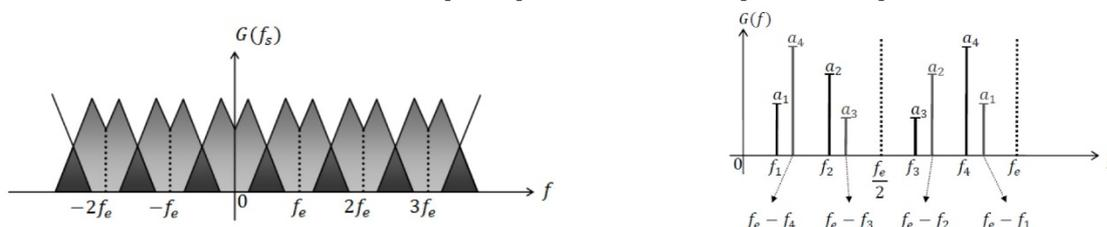
Figure : Ci-dessus, deux exemples de repliement de spectres.
