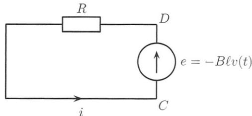
Schéma électrique équivalent à la situation. La fem induite est orientée en convention générateur (dans le même sens que  $i$ ).
