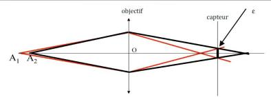
On démontre alors que la PDC vérifie la relation suivante :  $A_1A_2 = 2\varepsilon d^2 \frac{NO}{f^2}$  où d est la distance de mise au point (d = OA, A étant le point objet, visé par le photographe, sur lequel le point est fait) et f la focale de l'objectif.
