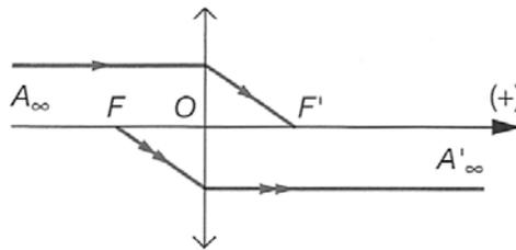
Si on considère un rayon incident passant par le point  $F$ , symétrique de  $F'$  par rapport au centre optique  $O$ , le rayon émergent est parallèle à l'axe optique.  $F$  se révèle donc conjugué avec un point image  $A'$ , situé à l'infini sur l'axe :  $F$  est le foyer objet de la lentille.
