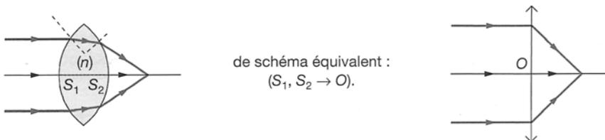
Le point  $F'$  d'intersection du rayon émergent avec l'axe est identique pour tous les rayons incidents parallèles à l'axe. Cette propriété découle du stigmatisme approché, obtenu dans les
