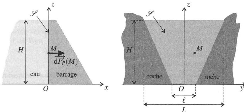
b) Force de pression sur un barrage plan type Serre Ponçon
