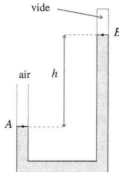
Baromètre de Torricelli.
