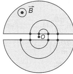
Le problème avec les cyclotrons de grande taille est la nécessité de créer un champ magnétique sur la totalité de la surface du cyclotron. En pratique, il faut de très grandes quantités de fer. Afin de pallier ce problème, on peut envisager de créer un champ magnétique uniquement sur le périmètre d'un cercle. C'est le principe d'un synchrotron.
