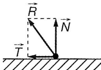
La partie normale de la réaction possède une caractéristique importante : elle doit absolument être dirigée du support vers le point matériel.
