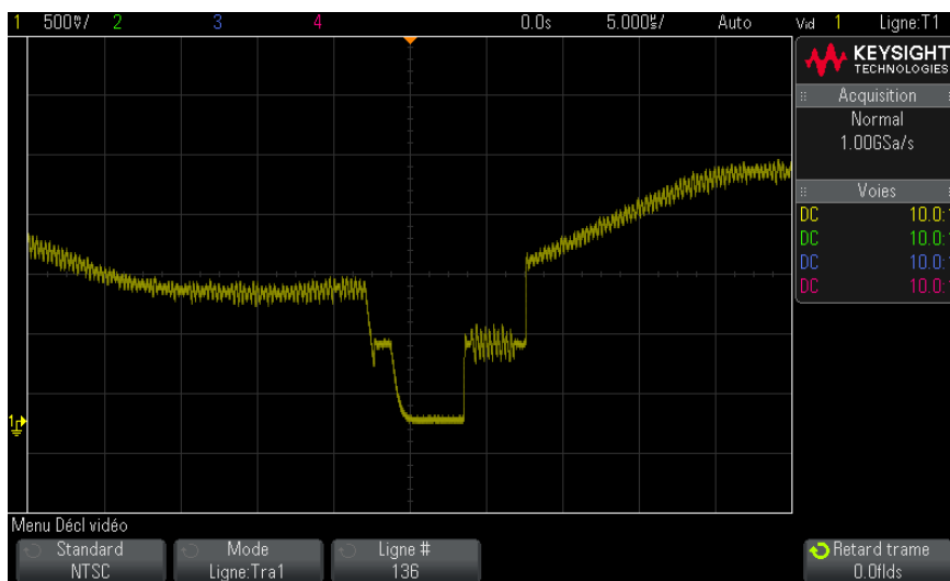
Figure 15 Exemple : déclenchement sur la ligne 136
