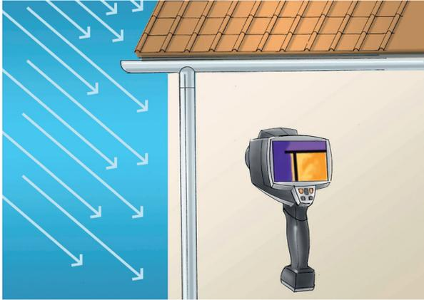
Figure 2.1 : Réflexions lors des mesures à l'extérieur
