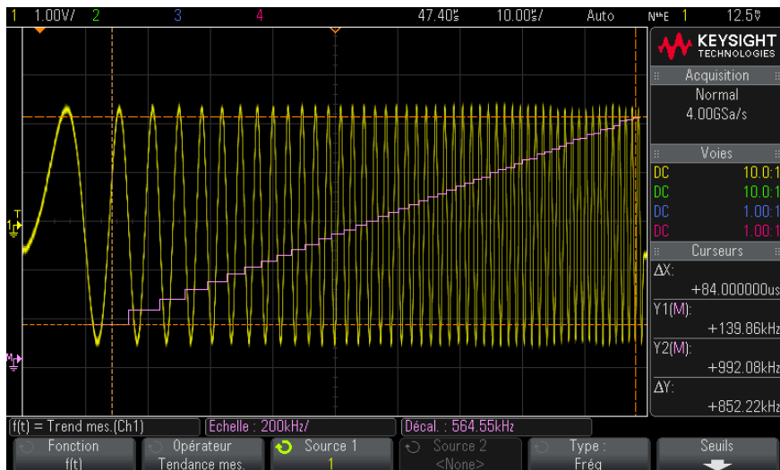
Figure 17 Exemple de tendance de mesure
