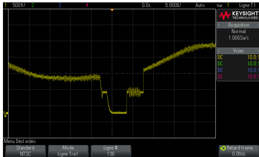
Figure 27 Exemple : déclenchement sur la ligne 136
