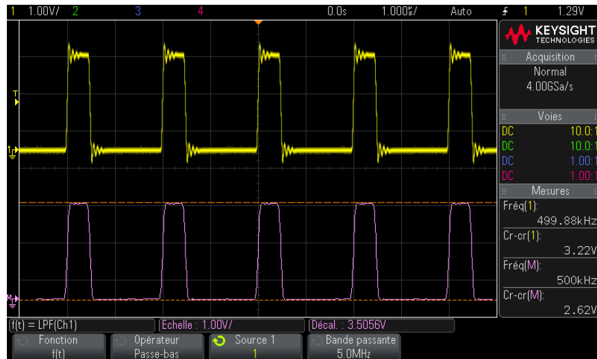
Figure 15 Exemple de filtre passe-bas
