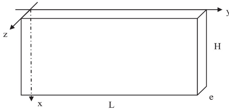
Figure 1 - Géométrie du conducteur thermique
