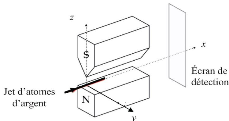
Figure 3 – Dispositif de l'expérience de Stern et Gerlach
