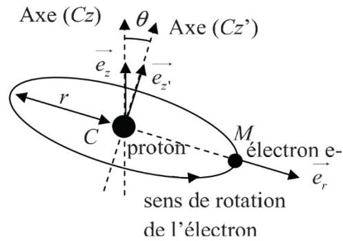
**Figure 5** – Modèle planétaire de l'atome d'hydrogène
