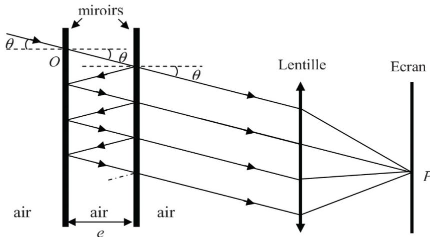
**Figure 7** – Interféromètre de Fabry – Pérot
