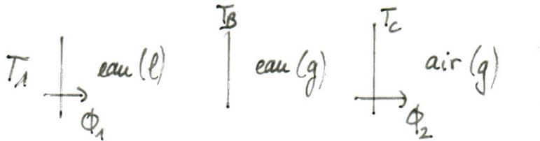
La partie représentée par le flux  $\phi$  est due au changement d'état de l'eau liquide en vapeur. Le reste correspond à l'association des résistances thermiques.
