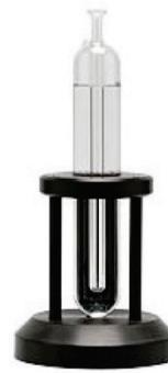
**Figure 1** Appareil à point triple de l'eau
