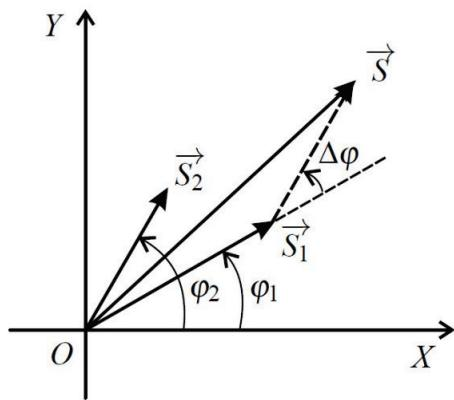
Addition des vecteurs de Fresnel correspondant à deux signaux sinusoïdaux de même fréquence. Les vecteurs sont représentés à l'instant  $t = 0$ .
