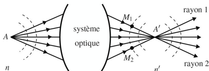
Avant le système optique, les rayons lumineux sont des droites passant par A. Les surfaces d'onde doivent être orthogonales à ces droites d'après le théorème de Malus ; ce sont donc des sphères de centre A. Pour une raison analogue les surfaces d'ondes, après le système optique, sont des sphères de centre A'.
