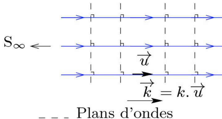
Exemples : Onde d'un faisceau laser, lumière provenant d'une source très éloignée
