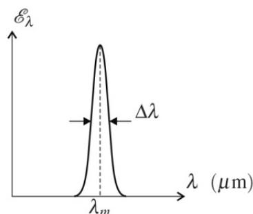
On sait mesurer le profil fin des raies spectrales. Ces raies ont une allure voisine de la figure ci-dessus et sont caractérisées par :
