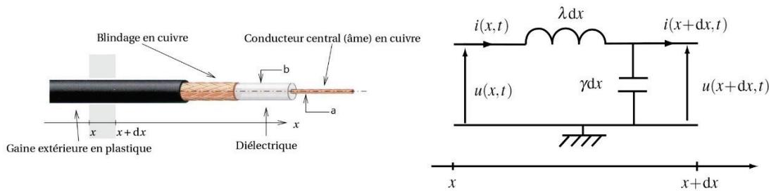
L'âme est un cylindre conducteur (en cuivre), le conducteur extérieur est constitué d'une tresse de fils de cuivre très fins, ces deux conducteurs étant séparés par un isolant. La tresse extérieure est reliée à la masse du réseau et l'âme « reçoit » le signal.
