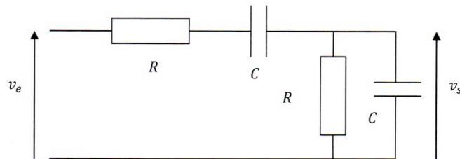
Montrer qu'il s'agit d'un filtre passe-bande et donner sa fréquence propre  $f_0$ .
