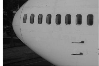
La figure suivante montre un tube de Pitot placé dans un écoulement d'air permanent et uniforme, à la vitesse constante  $\vec{v} = v \vec{u}_x$ , loin en amont du tube. On négligera l'influence de la pesanteur vu la faible taille du dispositif.
