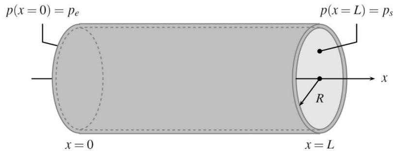
L'écoulement de Poiseuille correspond à l'écoulement d'un fluide réel à l'intérieur d'une conduite cylindrique de rayon  $R$ . L'axe de symétrie de révolution de la conduite est  $(Oz)$ . Pour forcer le liquide à s'écouler, un opérateur impose :
