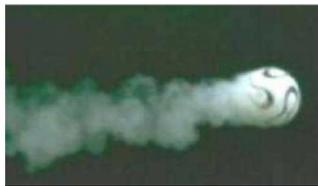
traînée turbulente d'un ballon de foot
