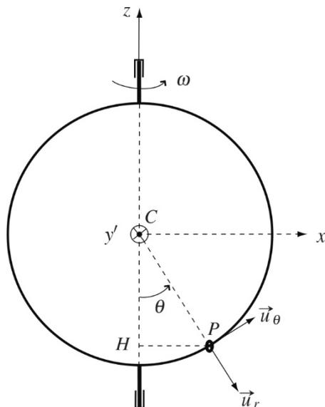
Une perle  $P$ , assimilée à un point matériel de masse  $m$ , est enfilée sur un cerceau de centre  $C$  et de rayon  $a$ . La perle se déplace sans frottement sur le cerceau. Le cerceau, situé dans un plan vertical, est entraîné par un moteur qui le fait tourner à vitesse angulaire constante  $\omega$  autour d'un diamètre vertical.
