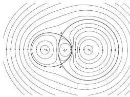
Le schéma représente les lignes de champ magnétique créé par trois fils infiniment longs, perpendiculaires au plan du schéma, parcourus par les courants  $I_1$ ,  $I_2$  et  $I_3$ . Par convention, un courant dirigé vers le lecteur est positif.
