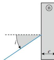
A.N :  $i_1=45^\circ$ ,  $n=1,5$  &  $e=5\text{mm}$
