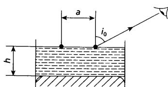
On observe un des fils sous une incidence  $i_0$  donnée, et on règle  $h$  de façon que l'image de l'autre fil coïncide avec le fil observé. Donner l'expression de  $n$  en fonction de  $i_0, a$  et  $h$
