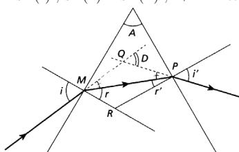
2°) Démontrer que pour un faisceau parallèle faisant un petit angle avec la normale à la face d'entrée du prisme de petit angle A on a :  $D = (n - 1)A$ .
